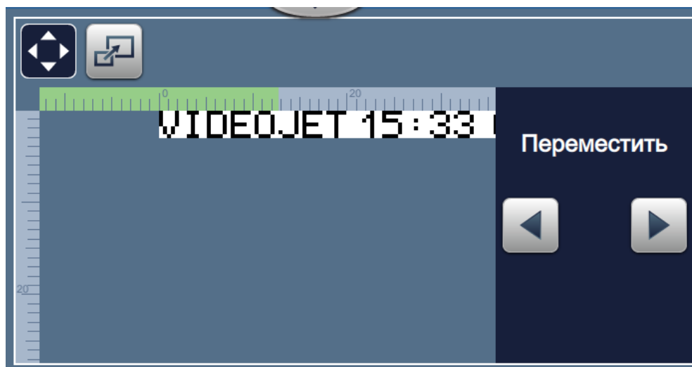
Рис. 8-2: Регулировка позиции печати – движение
