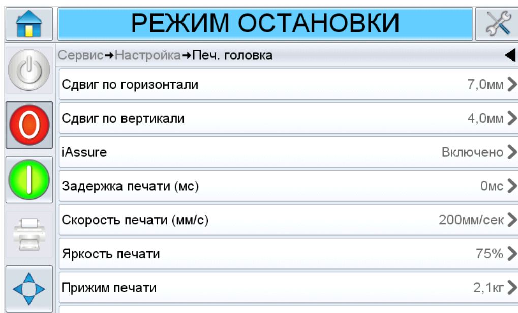
Рисунок 6-10: Страница установки печатающей головки для применения в непрерывном режиме
