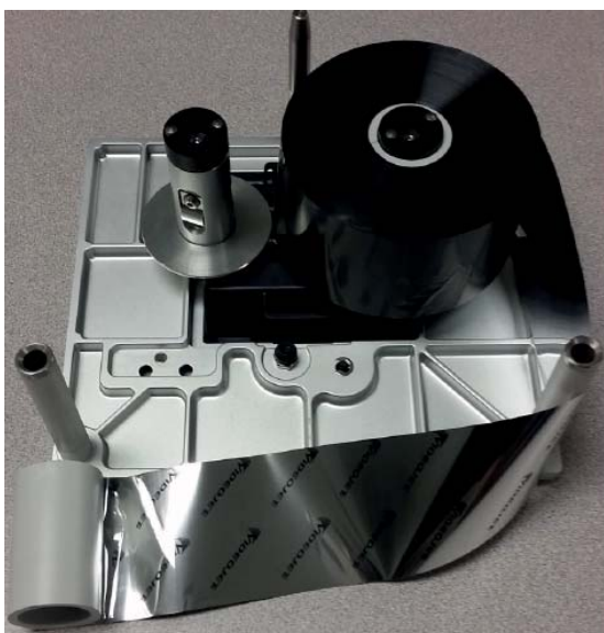
Рис. 4-12: Установка рулона ленты
