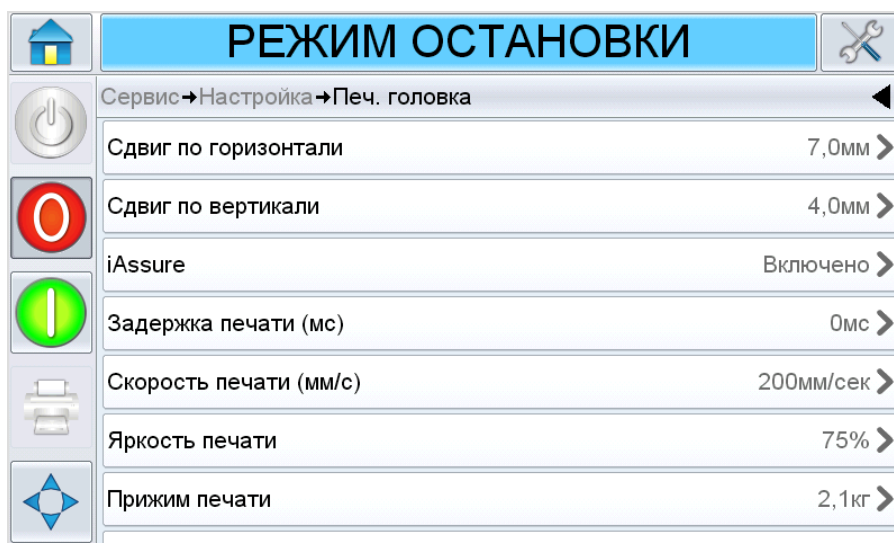
Рисунок 6-9: Страница установки печатающей головки для применения в прерывистом режиме
