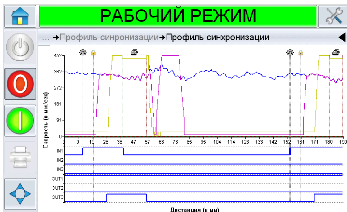
Рис. 5-15: График профиля энкодера
