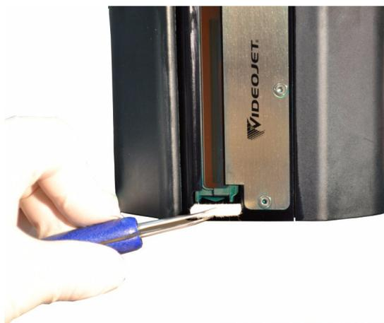
Рисунок 4-25: Снятие прокладки для мелкого мусора (Videojet 2351/2361)
