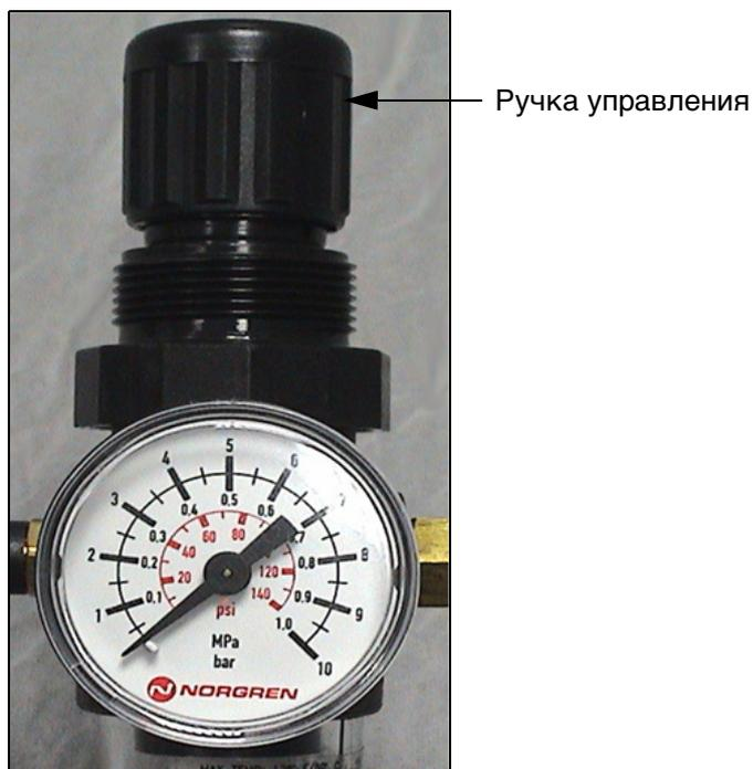
Рисунок 4-4: Воздушный регулятор для Videojet 2340, 2351 и 2361
