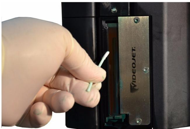
Рисунок 4-23: Очистка канала для чернил (Videojet 2351/2361)
