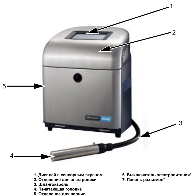
Рис. 3-1: Основные детали принтера
