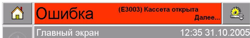
Рис. 5-5: Неисправность *Cassette Open* («Кассета открыта»)
