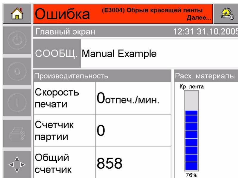
Рис. 5-1: Отображение неисправности
