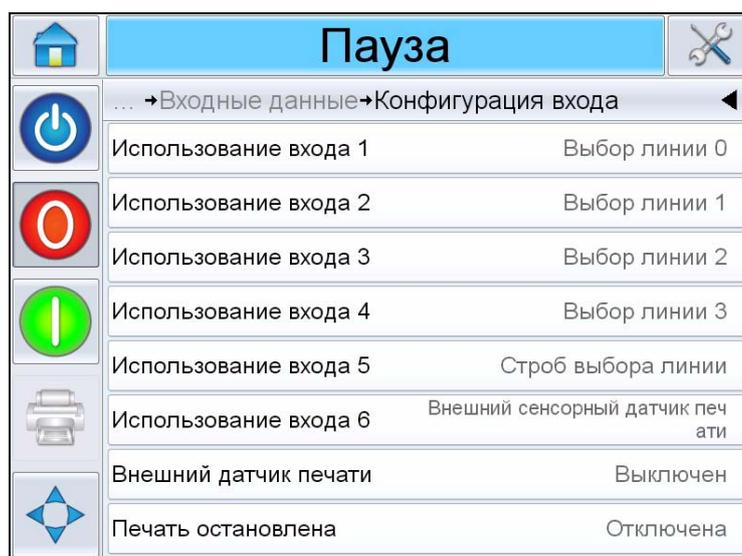
Рис. 4-10: Экран «Конфигурация входных данных»
