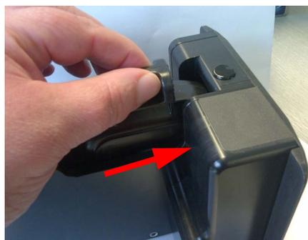
Рис. 6-22: Закрепление картриджа на месте
