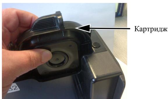
Рис. 6-21: Установка картриджа в печатающую головку
