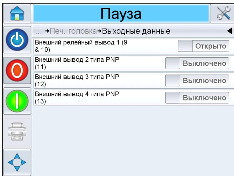
Рис. 4-13: Страница «Диагностика выходных данных печ. головки»
