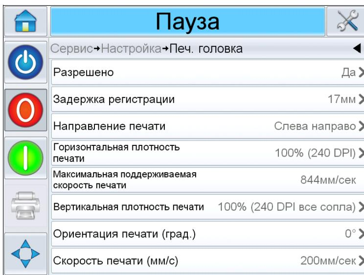
Рис. 4-4: Параметры печатающей головки
