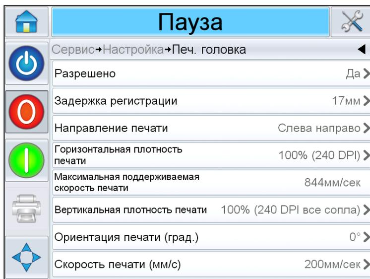
Рис. 5-16: Параметры печатающей головки
