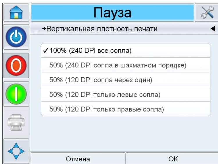
Рис. 5-21: Экран установки вертикальной плотности печати
