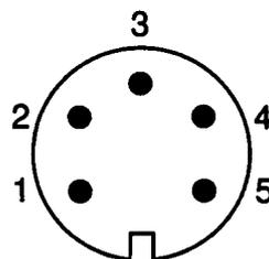
Разъем COMM 1 (гнездо на панели подключений), расположение контактов (вид снаружи)
