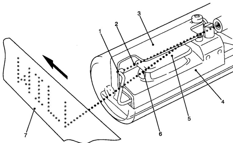
После прохождения через заряжающий электрод капельный поток проходит сквозь электростатическое поле двух отклоняющих электродов, на которые подается высокое напряжение (обычно 6 кВ). Отрицательно заряженные капли отклоняются в этом поле в направлении отклоняющего электрода высокого напряжения (5). Величина отклонения капли пропорциональна заряду этой капли, который в свою очередь пропорционален напряжению, подаваемому на заряжающий электрод в момент отрыва этой капли от струи.
