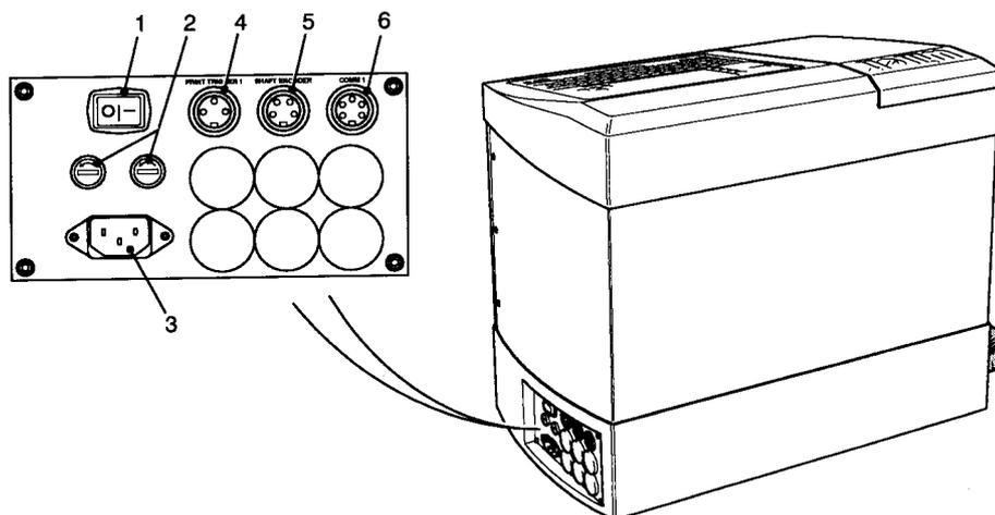
На панели подключений, расположенной на правой стороне корпуса принтера, находятся сетевой переключатель (1), сетевые предохранители (2), разъем сетевого кабеля (3), а также следующие разъемы для внешних соединений:
