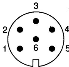
Разъем Status O/P (гнездо на панели подключений), расположение контактов (вид снаружи)
