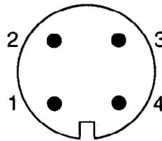
Разъем Shaft Encoder (гнездо на панели подключений), расположение контактов (вид снаружи)
