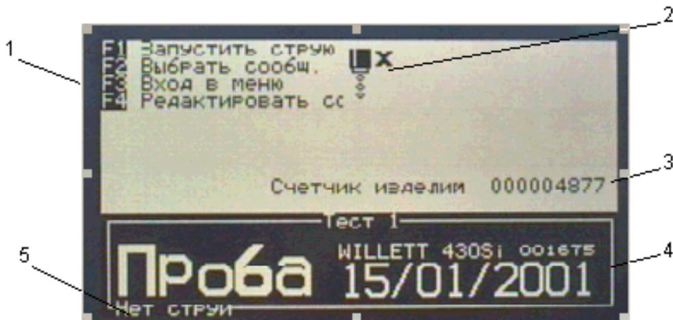
В левой верхней части экрана указано назначение функциональных клавиш (1).
