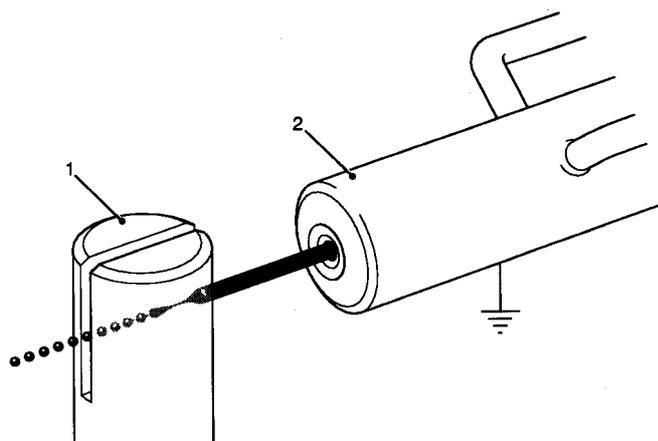
Заряжающий электрод (1) находится в точке распада чернильной струи на капли и охватывает участок струи протяженностью несколько капель в обе стороны от точки распада. Это обеспечивает некоторое допустимое отклонение точки распада от расчетного значения и защищает чернильный поток от влияния других электростатических полей. Расстояние от сопла (2) до заряжающего электрода составляет 3.5 мм.
