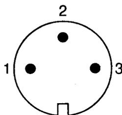
Разъем Print trigger 1 (гнездо на панели подключений), расположение контактов (вид снаружи)
