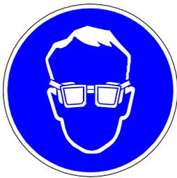
Во время технического обслуживания, наладочных или сервисных работ, которые проводятся вблизи открытого лазера и/или открытой системы, проводящей излучение, все лица, находящиеся в зоне действия лазера, должны надевать надлежащие защитные очки!
