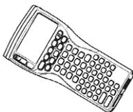
Ручной пульт управления служит для быстрой настройки лазерной системы. Подключение к блоку питания осуществляется через сетевой интерфейс. Ручной пульт управления может использоваться с любым количеством блоков питания. С его помощью вы можете:
